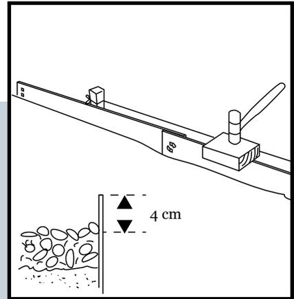
Tapotez doucement sur la fermeture de bordure pour qu'elle soit à la hauteur souhaitée. Veillez à laisser au maximum 4 cm visibles au-dessus du niveau du sol pour une stabilité optimale.
