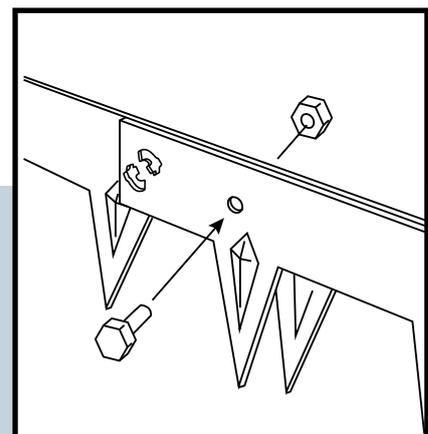
Vous pouvez si vous le souhaitez fixer les parties qui dépassent en y perçant un trou et en fixant les parties les unes aux autres à l'aide d'un boulon et d'un écrou (du même type de métal que la délimitation de bordure). Utilisez alors pour les finitions revêtues une couche primaire pour protéger les matériaux contre la corrosion.
