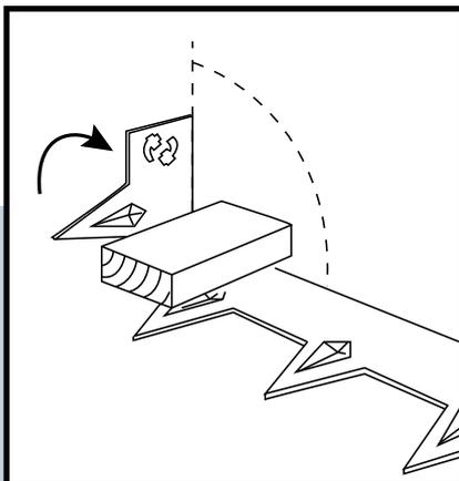
Vous pouvez fléchir la délimitation de bordure à l'aide d'un établi (en cas d'utilisation d'un établi à vis, prendre des blocs en bois pour éviter les rayures) ou d'un bloc de bois. Repliez les parties à la main pour créer un cercle ou une forme libre.
