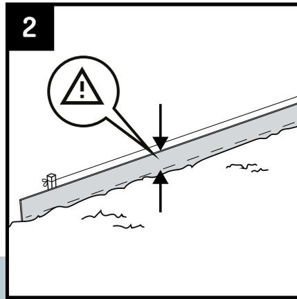
Placez la bordure dans la tranchée. Veillez à ce qu'au moins la moitié de la bordure soit sous terre. La bordure est encore plus stable si elle est placée plus profondément dans le sol. La bordure peut être raccourcie avec une scie égoïne pour le bois.
