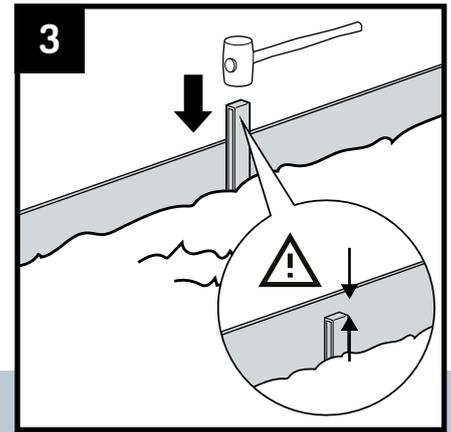
Placez des piquets le long de la bordure. Enfoncez-les dans le sol avec un marteau en caoutchouc. Veillez à ce que les piquets soient à quelques centimètres au-dessous du bord supérieur de la bordure. Placez un piquet tous les 50 cm. Après l'installation, les piquets doivent être invisibles.
