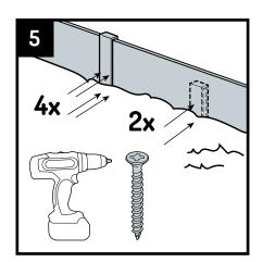
Golpee con cuidado el borde hasta la altura deseada con un mazo de goma. Atornille las estacas a la bordura. Utilice 2 tornillos de acero inoxidable de 4 x 30 mm. Atornille una estaca utilizado como transición entre dos borduras con 4 tornillos.
