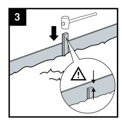
Coloque estacas a lo largo de la bordura. Clávelas en el suelo con un mazo de goma. Asegúrese de que las estacas ter- minen unos centímetros más abajo que el borde superior de la bordura. Coloque una estaca cada 50 cm. Las estacas deja- rán de ser visibles tras la instalación.
