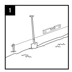
Cave una franja. Asegúrese de que al menos la mitad de la bordura pueda desaparecer en la zanja. Para un contorno recto, utilice cuerdas y estacas para marcar la línea sobre la que se debe colocar el Multi-Edge ECO para obtener un resultado más ajustado.
