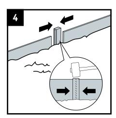
Se pueden introducir los extremos de la bordura en el perfil de una estaca. Esto no es necesario, pero podría proporcionar más estabilidad y ajuste. Se pueden crear esquinas cortando la bordura y colocándolo una contra otra en el ángulo deseado.
