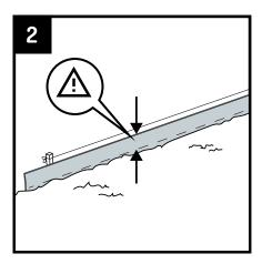
Coloque la bordura en la zanja. Asegúrese de que al menos la mitad de la pieza quede en el suelo. La bordura será aún más estable si se coloca a mayor profundidad en el suelo. La bordura se puede acortar con una sierra manual para madera.
