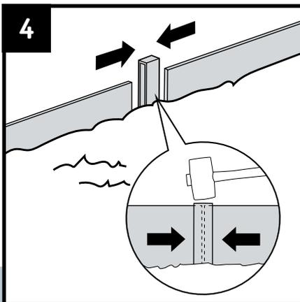
Es ist möglich, die Enden der Rasenkanten in das Profil eines Befestigungspfahls einzustecken. Dies ist nicht unbedingt erforderlich, gewährleistet aber einen stabilen, reibungslosen Übergang. Exakte Ecken können hergestellt werden, indem die Rasenkante durchgesägt und im gewünschten Winkel gegeneinander platziert wird.
