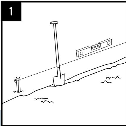
Graben Sie einen Graben. Stellen Sie sicher, dass mindestens die Hälfte der Rasenkante im Graben verschwinden kann. Markieren Sie für eine geraden Verlauf der Rasenkante mit einem Seil und kleinen Holzpfählen eine Linie, an der die Multi-Edge ECO platziert wird. So erhalten Sie ein besonders genaues Ergebnis.
