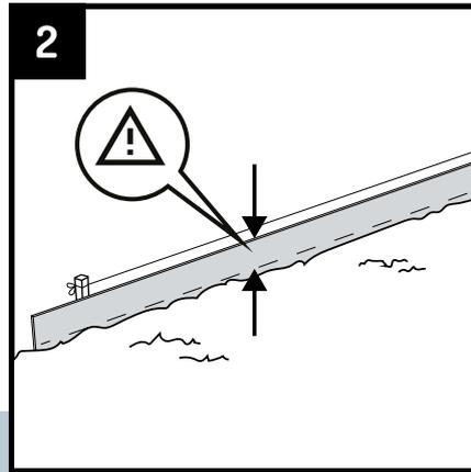
Legen Sie die Rasenkante in den ausgehobenen Graben. Stellen Sie sicher, dass mindestens die Hälfte der Rasenkante im Boden liegt. Die Rasenkante ist noch stabiler, wenn sie tiefer im Boden liegt. Die Rasenkante kann mit einer Handsäge für Holz gekürzt werden.
