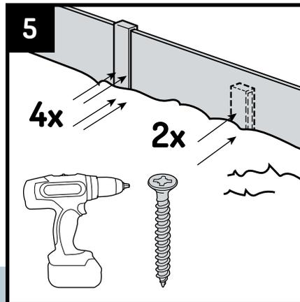
Klopfen Sie mit einem Gummihammer vorsichtig auf die gewünschte Höhe. Schrauben Sie die Befestigungspfähle an die Rasenkante. Verwenden Sie dazu 2 Edelstahlschrauben von 4 x 30 mm. Befestigen Sie einen Befestigungspfahl, der als Übergang zwischen zwei Rasenkanten verwendet wurde, mit 4 Schrauben.
