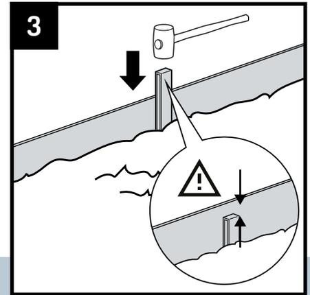
Platzieren Sie die Befestigungspfähle entlang der Rasenkante und schlagen Sie sie mit einem Gummihammer in den Boden. Stellen Sie sicher, dass die Befestigungspfähle einige cm tiefer als die Oberkante der Rasenkante sind. Platzieren Sie alle 50 cm einen Befestigungspfahl. Die Befestigungspfähle sind dann nach dem Bau nicht mehr sichtbar.
