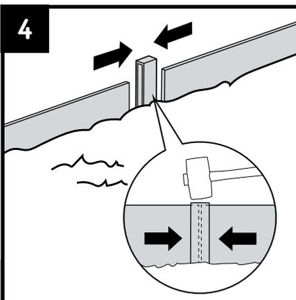
Vous pouvez insérer les extrémités des bordures dans le profil d'un piquet. Cela n'est pas forcément nécessaire, mais vous obtiendrez ainsi une transition stable et nette. Vous pouvez obtenir des angles bien nets en sciant à travers la bordure et en les plaçant l'une contre l'autre selon l'angle de votre choix.
