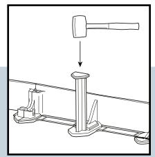
Con la ayuda de un martillo clave las estacas con cuidado. Utilice todas las estacas incluidas en el paquete para una estabilidad óptima.
