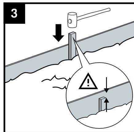
Platzieren Sie die Befestigungspfähle entlang der Rasenkante und schlagen Sie sie mit einem Gummihammer in den Boden. Stellen Sie sicher, dass die Befestigungspfähle einige cm tiefer als die Oberkante der Rasenkante sind. Platzieren Sie alle 50 cm einen Befestigungspfahl. Die Befestigungspfähle sind dann nach dem Bau nicht mehr sichtbar.
