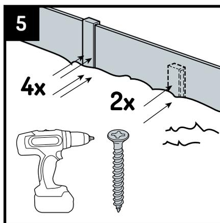
Tapez doucement sur la bordure avec un marteau en caoutchouc pour l'enfoncer à la hauteur souhaitée. Vissez les piquets sur la bordure. Utilisez pour cela 2 vis en acier inoxydable de 4 x 30 mm. Avec 4 vis, fixez un piquet utilisé comme transition entre deux bordures.
