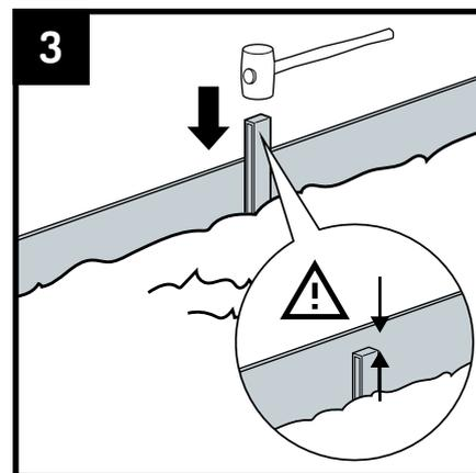
Placez des piquets le long de la bordure. Enfoncez-les dans le sol avec un marteau en caoutchouc. Veillez à ce que les piquets soient à quelques centimètres au-dessus du bord supérieur de la bordure. Placez un piquet tous les 50 cm. Après l'installation, les piquets doivent être invisibles.
