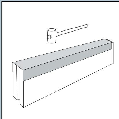
La instalación del perfil es muy sencilla. Coloque el perfil sobre el bordillo. No es necesario fijarlo con material adicional. Coloque el siguiente perfil o pieza de esquina firmemente de manera contigua lo más próximo posible, de modo que no se vea nada del bordillo de hormigón ya existente.
