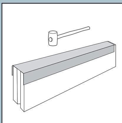
L'installation du profil est très simple. Placez le profil sur la bordure. Il n'a pas besoin d'être fixé. Placez le profil suivant ou la pièce d'angle bien contre le précédent afin qu'aucun bord de la bordure ne soit visible.
